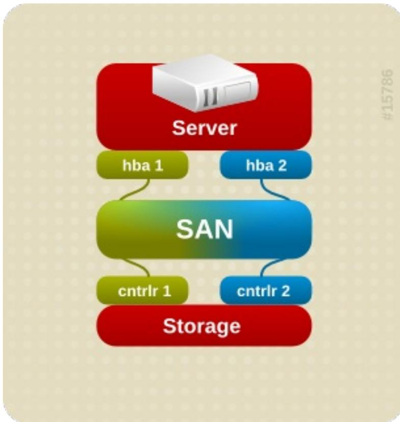
圖形 1.3. 以一個 RAID 裝置來進行 Active/Active Multipath 的配置
