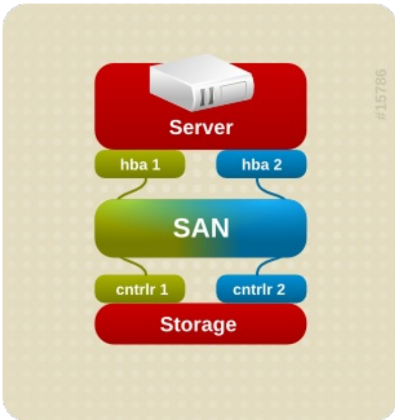
图 1.3. 带一个 RAID 设备的主动/主动多路径配置
