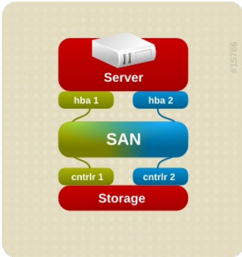
그림 1.3. 하나의 RAID 장치로 활성/활성 멀티패스 설정
