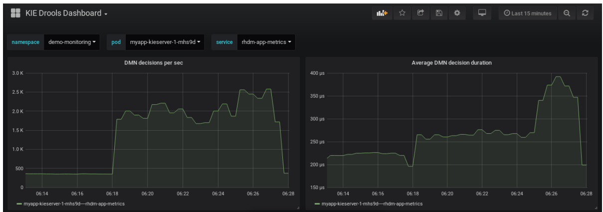
図15.4 Grafana ダッシュボードとソルバーの KIE Server メトリック
